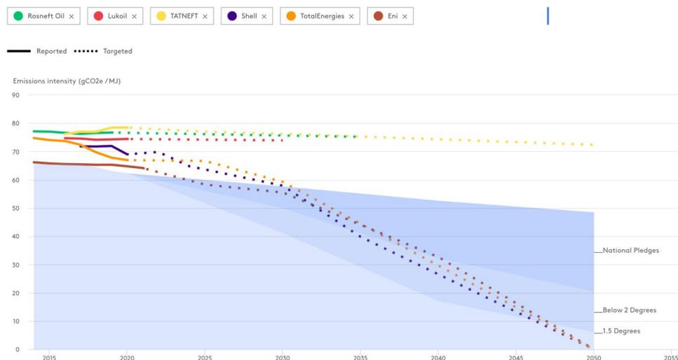
**Рисунок 4. Выбросы CO<sub>2</sub> выбранных нефтегазовых компаний и их поставленные цели.**
